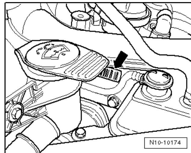
在发动机和变速箱的连接处-箭头-也有发动机代码和发动机编码。
